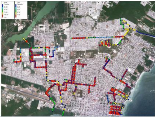
Figura 14. Colectores operando a su máxima capacidad con una lluvia de 10 años
