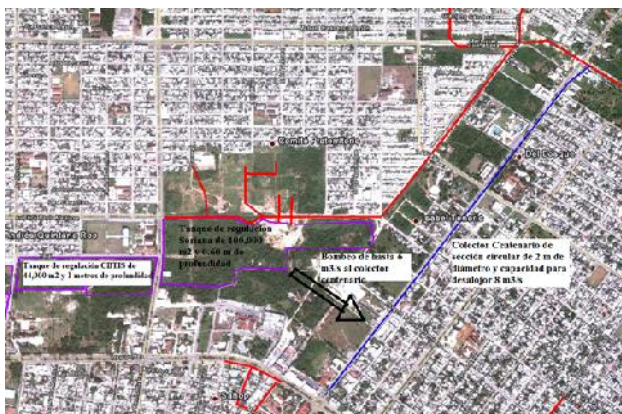
Figura 20. Tanque de regulación, bombeo y colector paralelo al dren Soriana
